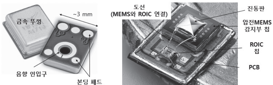
| 그림 12. Vesper사의 AlN 기반 microphone 제품 및 내부 구조 |
