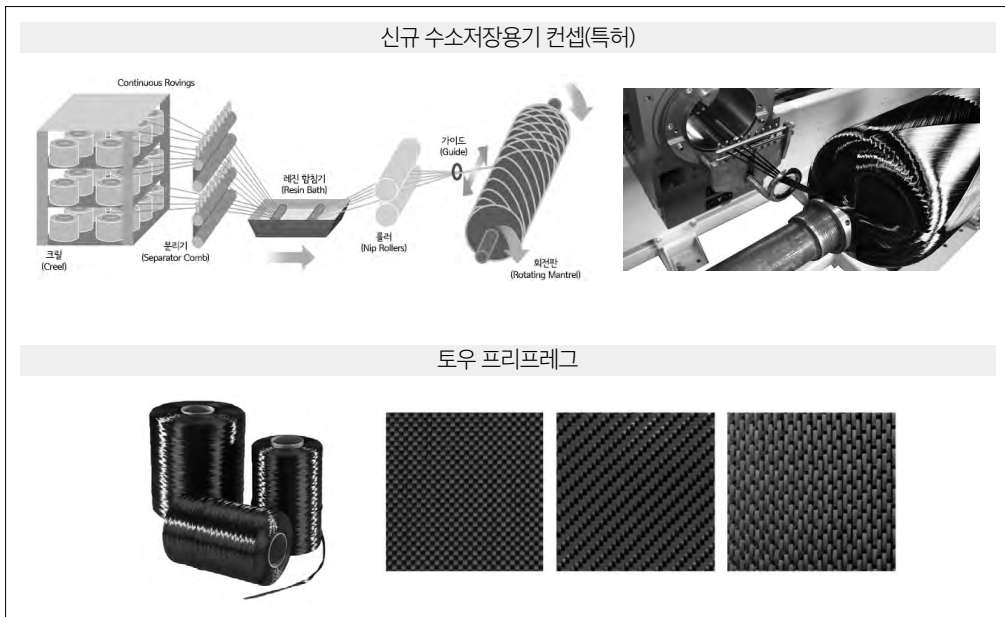
[그림 7] 습식필라멘트 와인딩 개략도 및 토우프리프레그
