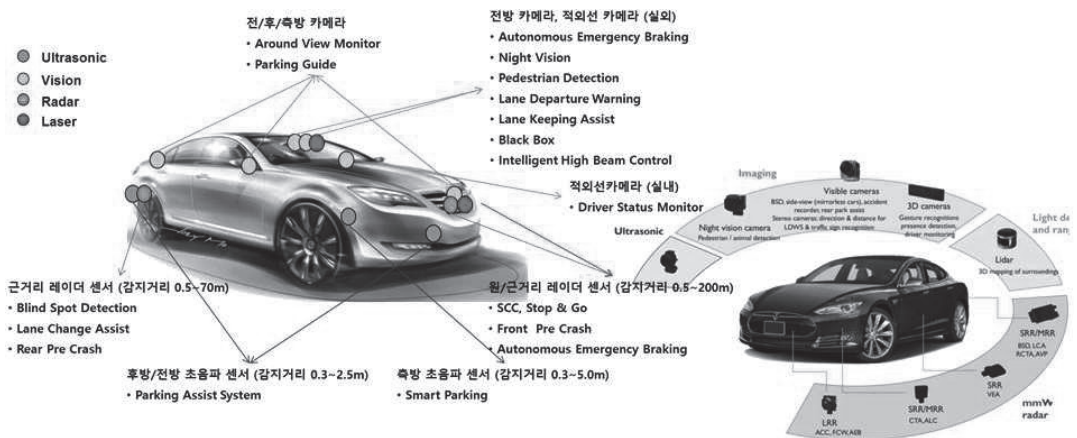
| 그림 4. 양산 적용중인 차량용 인지센서 유형 및 응용 분야 |
